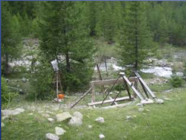
Trépieds des miroirs et des viseurs : Entièrement démontable
